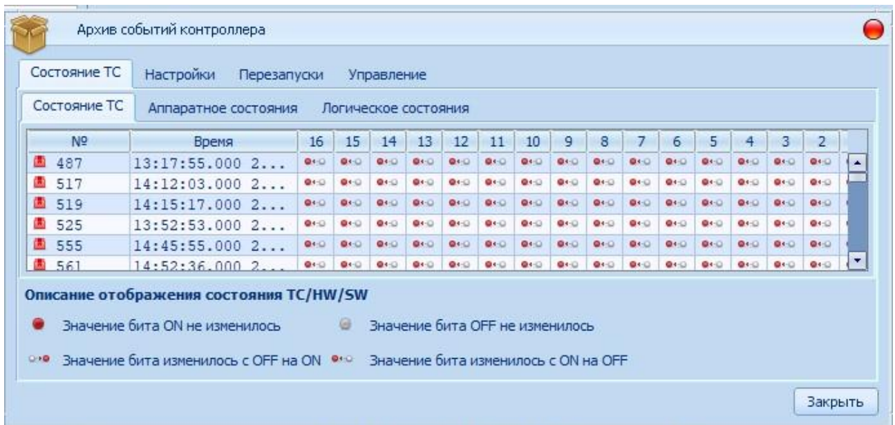
Рис. 8. Вкладка «Состояние ТС » архива событий контроллера.
